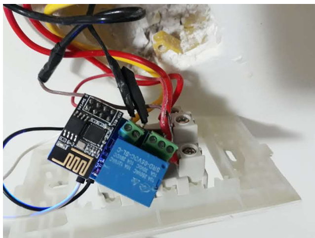
Figura 10 – Foto do ESP01 com as ligações elétricas feitas.
